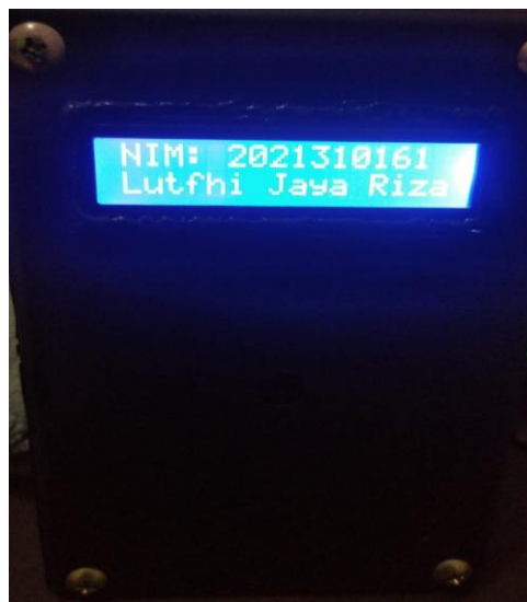
Gambar 6. ESP32 Devkit mengambil data terakhir dari Supabase dan menampilkannya ke LCD
