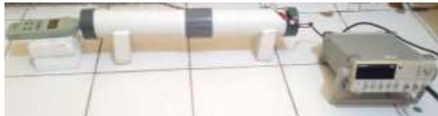
**Gambar 1** Alat tabung impedansi
