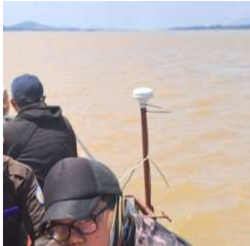
Gambar 1. Alat pemancar sinyal yang terpasang pada speedboat pada saat pengambilan data batimetri.
