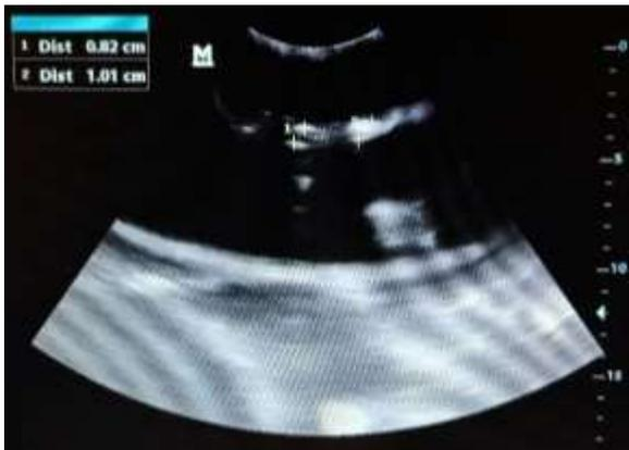
**Gambar 4.** Hasil citra pengukuran diameter objek *phantom* air
