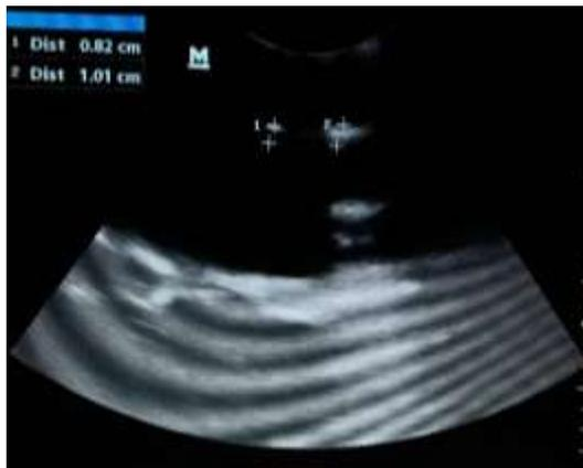
**Gambar 6.** Hasil citra pengukuran diameter objek *phantom* oli
