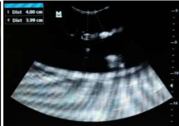
**Gambar 5.** Hasil citra pengukuran kedalaman jarak objek *phantom* air
