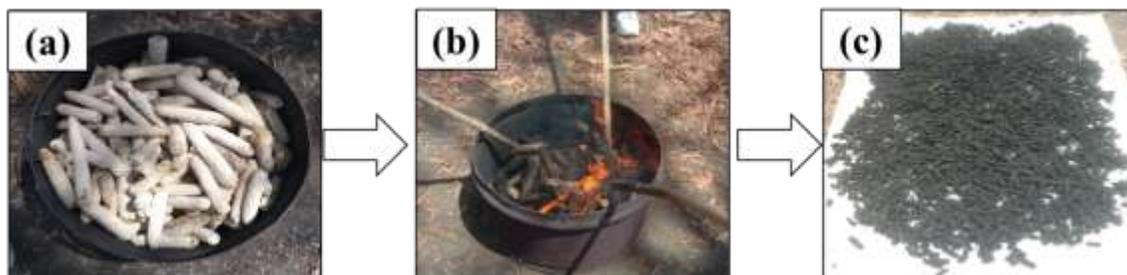
**Gambar 2.** Proses pembuatan arang (a) tongkol jagung, (b) pembakaran dan (c) arang tongkol jagung.
