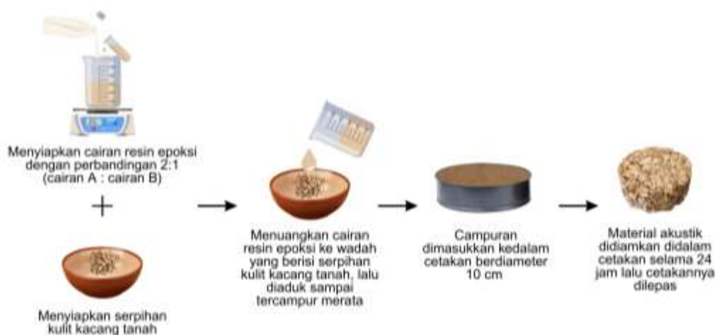
Gambar 2. Pembuatan material akustik.
