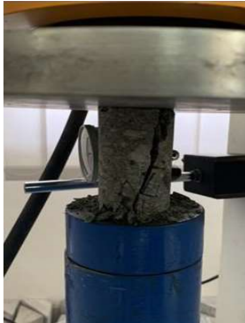
Gambar 4. Pengujian kuat geser (sifat mekanik batuan).
