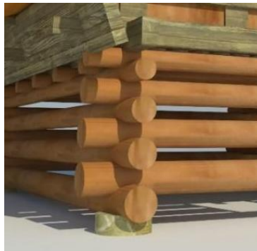
Gambar 5. Cara Penyusunan Balok Sumber: Ilustrasi Bentuk, 2017
