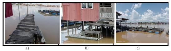
**Gambar 6.** Tampilan Kondisi Elemen Lingkungan di Kampung Bangka Belitung a) Gertak yang Menjorok ke Sungai, B) Pelantaran Rumah, C) Konstruksi Apung Tambak
