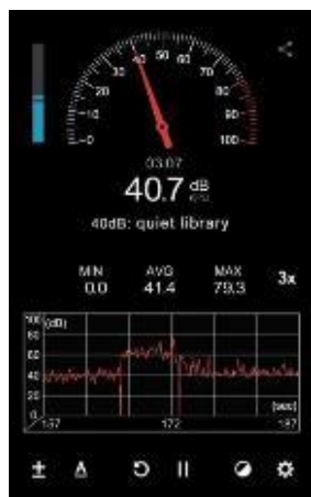
Gambar 3. Pengukuran menggunakan aplikasi sound level meter Sumber: Hasil Dokumentasi (2025)
