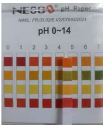
Gambar 1. Pengujian tingkat keasaman tomat busuk
