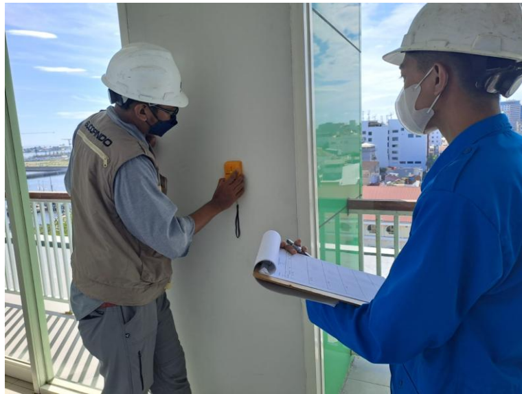
Gambar 3. Pengukuran dengan rebar scan
