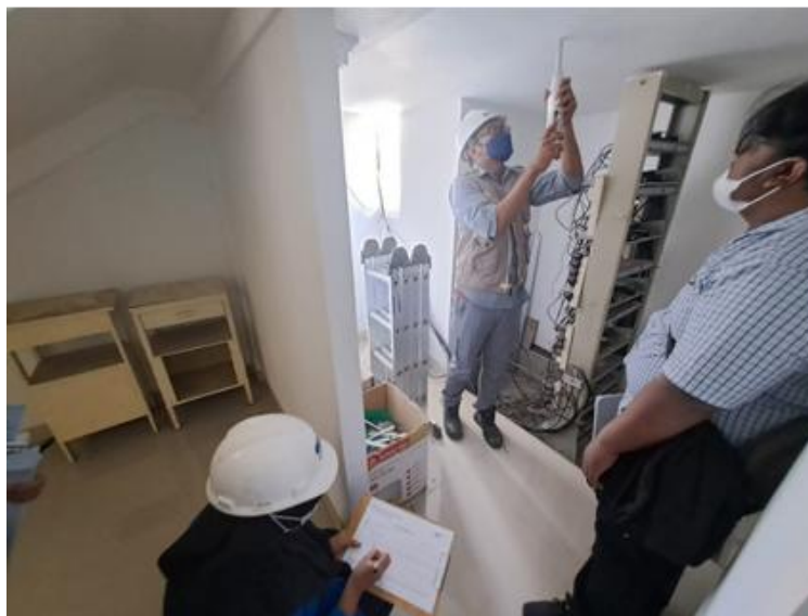
Gambar 2. Pengukuran dengan hammer test
