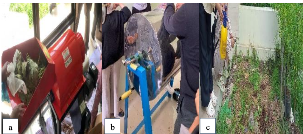
Gambar 1. Tahapan penelitian meliputi: (a) pencacahan sampah, (b) pengadukan sampah dengan bioactivator starter , dan (3) penyemprotan bioactivator starter
