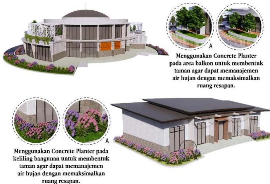
Gambar 5. Concrete Planter Bangunan Utama Sumber: Hasil Desain, 2025
