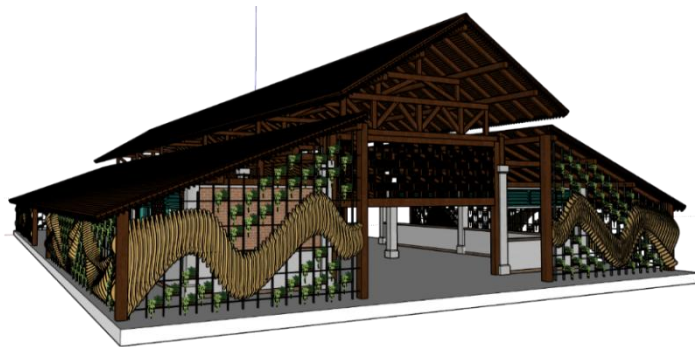
Gambar 1. Ventilasi alami bangunan Sumber: Hasil Desain (2025)
